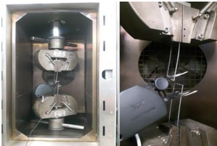
ภาพที่ 4 การทดสอบคุณสมบัติของวัสดุด้วยเครื่องทดสอบวัสดุ (Tensile Testing Machine)
