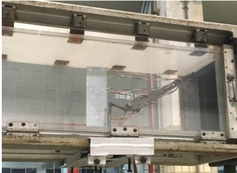
ภาพที่ 10 การทดสอบผ่านบางเสมือนปีกในอุโมงค์ลม
