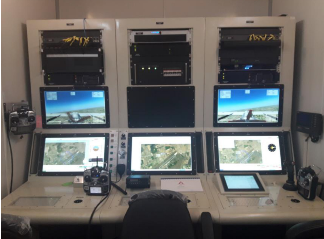
ศูนย์ควบคุมภาคพื้นดิน (Ground Control Station)
